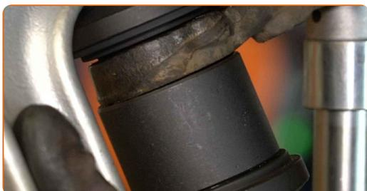
**27** Limpe o local de montagem da rótula de suspensão. Use uma escova metálica. Use o spray de limpeza universal.
