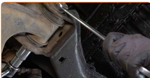
**17** Desaparafuse o fixador traseiro do braço de controlo. Use uma chave combinada nº 22. Use uma chave soquete nº 22. Use uma chave de catraca.
