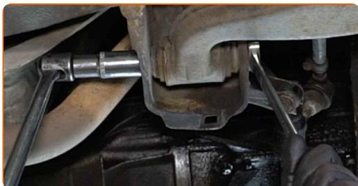
**18** Desaparafuse o fixador que liga a junta esférica à manga do eixo. Use uma chave combinada nº 19. Use uma chave soquete nº 19. Use uma chave de catraca.
