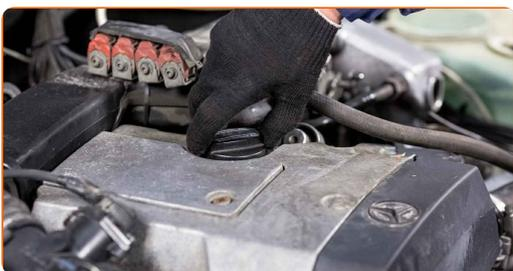
**4** Desaperte a tampa da caixa do filtro em conjunto com o antigo elemento do filtro. Use o soquete 62-23F. Use uma chave de catraca.
