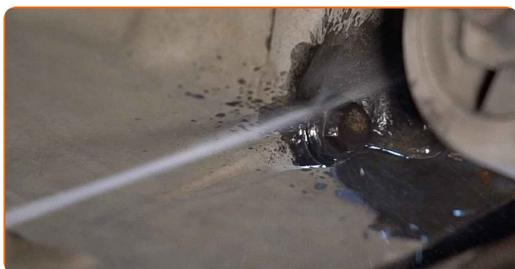
**18** Desaperte o bujão de drenagem. Use uma chave soquete nº 24. Use uma chave de catraca.
