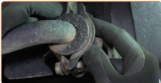
**45** Aperte as porcas nos casquilhos dos suportes da barra estabilizadora. Use uma chave combinada nº 13. Use uma chave soquete nº 13. Use uma chave de torque. Aperte-o para o torque de 20 Nm.
