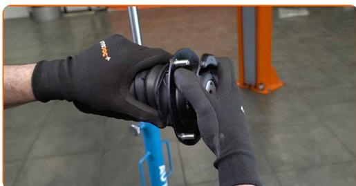
**35** Aparafuse as porcas do cabeçote do amortecedor.
