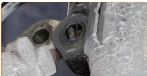
**20** Limpe os fixadores dos suportes da bucha da barra estabilizadora. Use uma escova metálica. Use spray WD-40.
