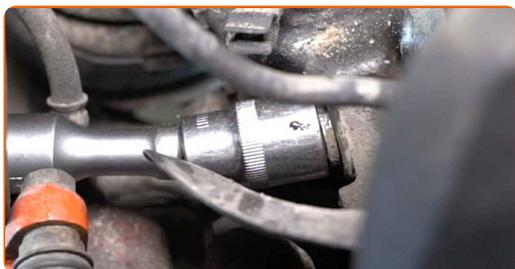
**18** Retire os parafusos de fixação.
