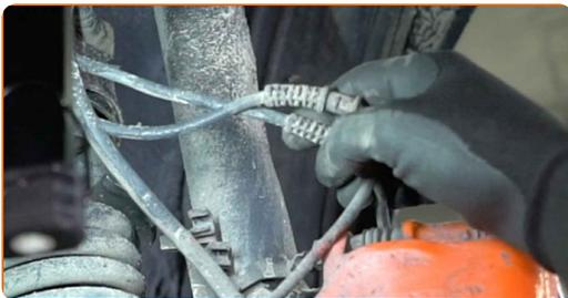
**17** Desaparafuse os fixadores inferiores do amortecedor. Use uma chave soquete nº 19. Use uma chave de catraca.
