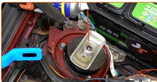
**5** Desaperte as porcas do cabeçote do amortecedor. Use uma chave soquete nº 13. Use uma chave de catraca.
