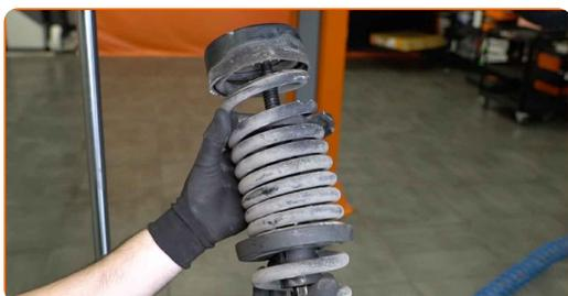
Substituição: cabeçotes do amortecedores – MERCEDES-BENZ Classe E Coupe (C124). Conselho:
