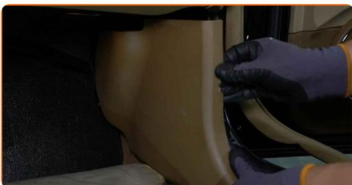
**5** Desenrosque os elementos de fixação do painel lateral do lado do passageiro. Use Torx T20.
