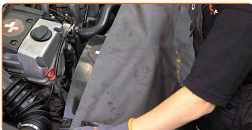
**3** Limpe o suporte de montagem do filtro de combustível. Use o spray de limpeza universal.
