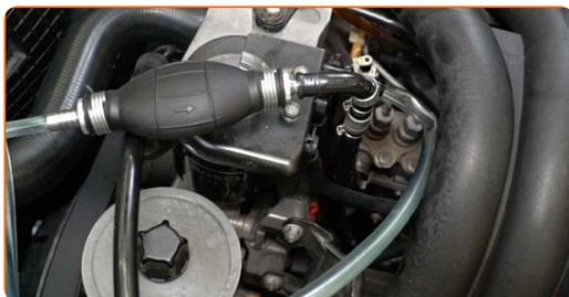
**15** Aperte o grampo de fixação do tubo do filtro de combustível. Use a chave Phillips.
