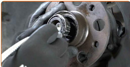
**25** Remova o cubo de roda juntamente com o rolamento.
