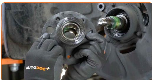
**26** Aperte o cubo de roda juntamente com o rolamento através de um torno.
