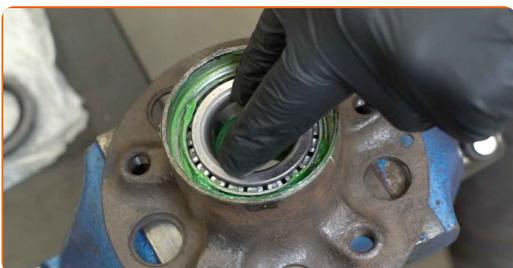
**40** Solte o torno e remova o cubo de roda juntamente com o rolamento.
