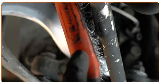
**10** Instale uma nova barra, aperte os parafusos de fixação. Utilize um pé-de-cabra.
