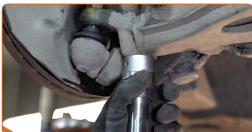
**18** Remova o parafuso de fixação. Use um saca-pino. Use um martelo de borracha.
