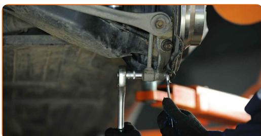
**9** Remova o parafuso de fixação.
