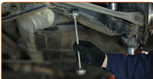
**13** Instale o parafuso de fixação.
