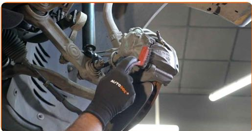
**12** Desparafuse a fixação de pinça de travão. Use uma chave combinada nº 17. Use uma chave soquete nº 13. Use uma chave de catraca.
