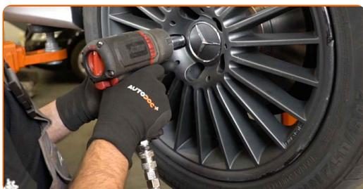
**29** Baixar o carro e trabalhar em ordem transversal, apertar os parafusos das rodas. Use o soquete de impacto para roda #17. Use uma chave de torque. Aperte-o para o torque de 130 Nm.
