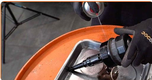
**16** Instale anéis em O novos e um filtro de óleo novo nos seus locais de montagem na tampa do filtro.
