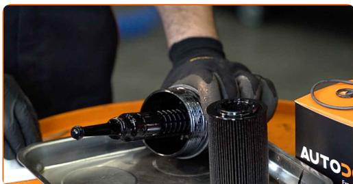
**14** Retire anéis em O antigos da tampa do filtro de óleo. Use uma chave de fenda plana.
