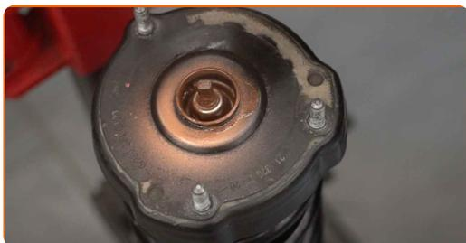
**41** Instale a tampa de proteção de suporte do amortecedor.
