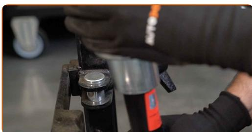
**43** Limpe os assentos de montagem da coluna do amortecedor.
