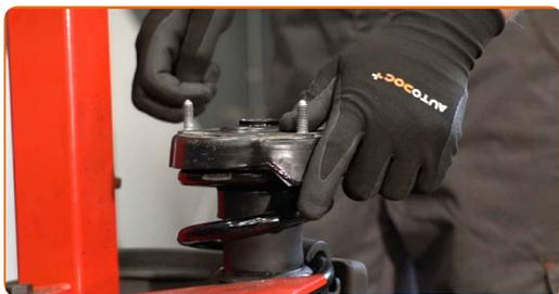
**38** Aperte a porca do suporte do amortecedor da haste do pistão. Utilize a chave para amortecedor n.º DD6. Use uma chave soquete n.º 18. Use uma chave de torque. Aperte-o para o torque de 23 Nm.
