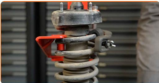
**25** Remova a tampa protetora do suporte do amortecedor.
