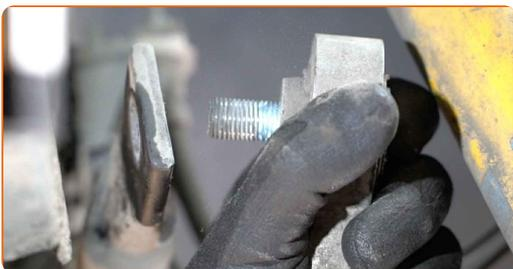
**21** Desapertar a fixação superior de montagem do suporte do amortecedor.
