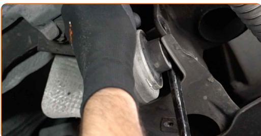
**17** Remova o parafuso de fixação. Use um saca-pino. Use um martelo.
