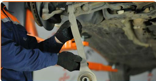
**13** Limpe os locais de montagem e a rosca do braço da suspensão. Use uma escova metálica. Use spray WD-40.
