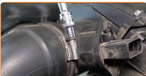
**5** Desconecte o tubo de entrada de ar do compartimento do filtro de ar.
