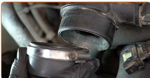
**6** Desaperte os parafusos de fixação da tampa do filtro de ar. Use uma chave soquete nº E11. Use uma chave de catraca.
