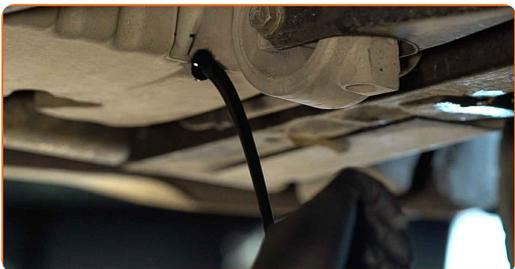
**Substituição: óleo do motor e filtro – MERCEDES-BENZ Classe G SUV (W461).**
