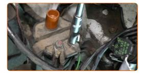
Desconecte os terminais da bobina de ignição.
