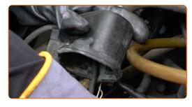
Desconecte o cabo de alta tensão da bobina de ignição.
