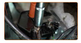
Conecte o cabo de alta tensão à bobina de ignição.
