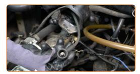
Desenrosque as porcas dos terminais da bobina de ignição. Use uma chave soquete nº 10. Use uma chave de catraca.
