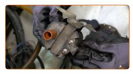
13 Instale uma nova bobina de ignição.
