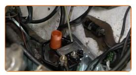
Enrosque as porcas dos terminais da bobina de ignição. Use uma chave soquete nº 10. Use uma chave de catraca.
