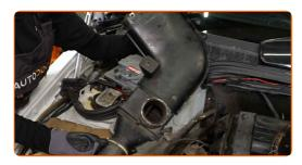
Remova a tampa da bobina de ignição.
