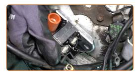
Enrosque os elementos de fixação da bobina de ignição. Use uma chave combinada nº 10.
