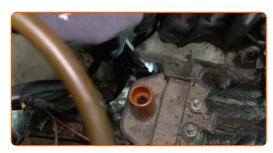
Remova a bobina de ignição.
