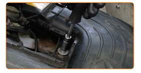
Retire os parafusos de fixação.
