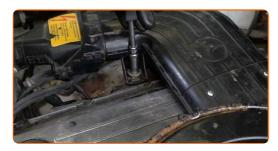
Conecte o terminal do cabo de terra à bateria.
