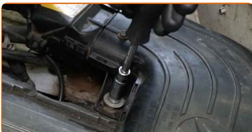
5 Retire os parafusos de fixação.
