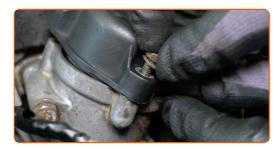
Aperte os fixadores da carcaça do termóstato. Use uma chave soquete nº 10. Use uma chave de torque. Aperte-o para o torque de 12 Nm.
