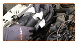
Desaparafuse os fixadores da carcaça do termóstato. Use uma chave soquete nº 10. Use uma chave de catraca.
