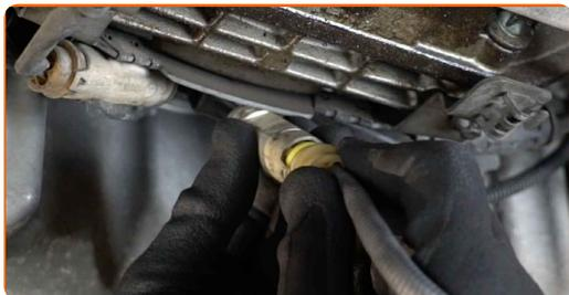
**18** Reinstale a tampa inferior do cárter de óleo.
