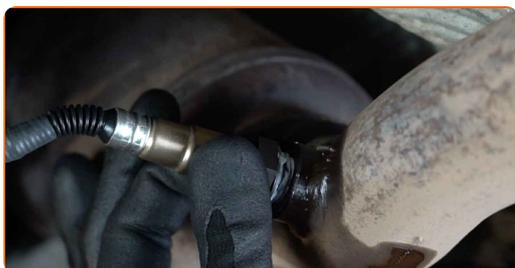
**15** Aperte o fixador do sensor de oxigénio. Use uma chave combinada nº 22. Use uma chave de torque. Aperte-o para o torque de 51 Nm.
