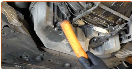
**9** Desaperte o bujão de drenagem. Use uma chave combinada nº 13. Use uma chave soquete nº 13. Use uma chave de catraca.
