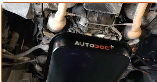
**8** Limpe a área do orifício de drenagem do cárter. Use uma escova metálica. Use o spray de limpeza universal.
