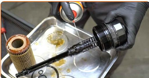
**19** Instale anéis em O novos e um filtro de óleo novo nos seus locais de montagem na tampa do filtro.
