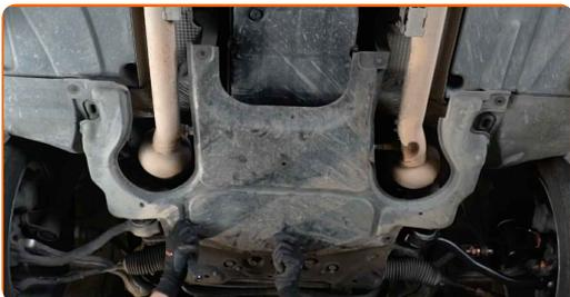
**27** Aperte os fixadores da tampa inferior do cárter. Use uma chave soquete nº 8. Use uma chave de catraca.
