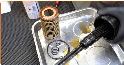
**17** Retire anéis em O antigos da tampa do filtro de óleo. Use uma chave de fenda plana.
