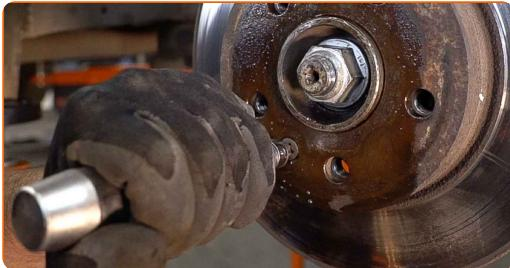
**Substituição: discos de travão – MERCEDES-BENZ Classe V (W638/2).**
