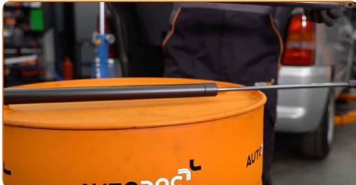
**Substituição: amortecedor da mala – MERCEDES-BENZ Classe V (W638/2).**
