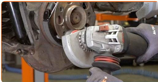
**33** Trate a superfície de contacto. Utilize massa lubrificante de cerâmica.
