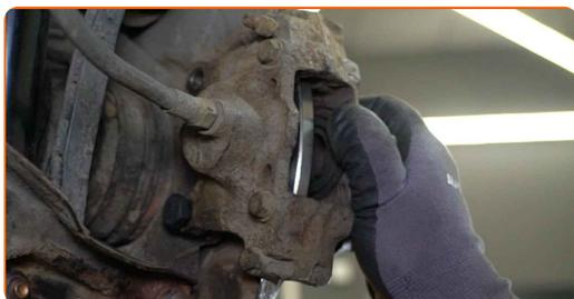
**39** Instale os parafusos de fixação.
