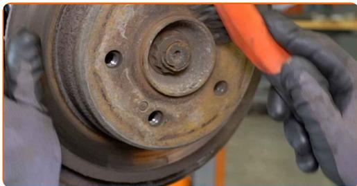
**18** Desaparafuse os fixadores do disco de travão. Use HEX n.º H5. Use uma chave de catraca.
