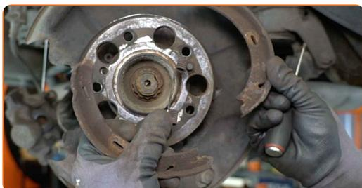
**26** Limpe os locais de montagem das maxilas do travão de estacionamento. Use uma escova metálica. Use o spray de limpeza universal.
