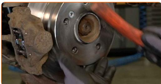
**45** Trate a superfície onde o disco de travão entra em contacto com o aro da roda. Utilize massa lubrificante de cerâmica.
