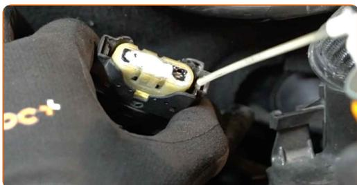
**17** Junte o conector do sensor de fluxo de massa de ar.
