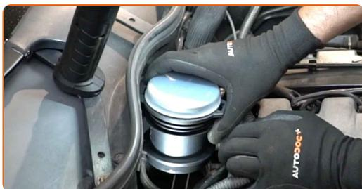
**15** Bloqueie os cliques de retenção do sensor de fluxo de massa de ar.
