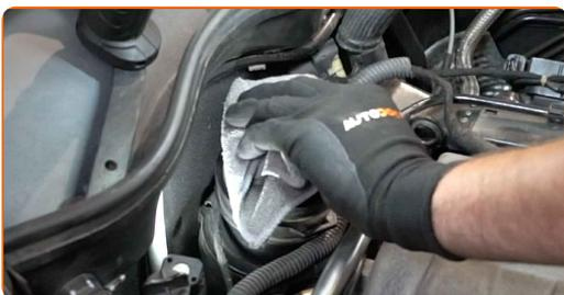
**10** Limpe o local de montagem do sensor de fluxo de massa de ar.
