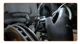
61 Conecte o cabo do sensor de desgaste da pastilha de travão.
