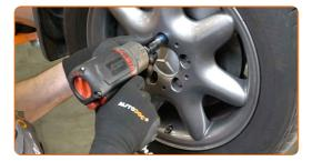
Baixar o carro e trabalhar em ordem transversal, apertar os parafusos das rodas. Use o soquete de impacto para roda #17. Use uma chave de torque. Aperte-o para o torque de 110 Nm.
