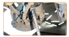
Aperte o fixador superior, que liga o dispositivo amortecedor à manga de eixo. Use uma chave soquete nº 21. Use HEX n.º H12. Use uma chave de torque. Aperte-o para o torque de 100 Nm.+90°
