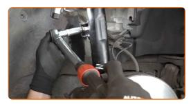
Trate todas as juntas de conexão do estabilizador. Trate os fixadores do amortecedor. Use massa de cobre.
