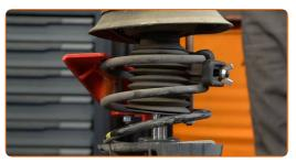
Trate a haste da coluna do amortecedor. Use uma escova metálica. Use spray WD-40.
