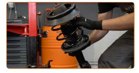
Trate dos assentos de montagem do amortecedor. Use uma escova metálica. Use spray WD-40.
