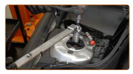
73 Trate os fixadores do apoio da coluna de suspensão. Use massa de cobre.
