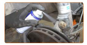
Desaparafuse o fixador superior, que liga o dispositivo amortecedor à manga de eixo. Use HEX n.º H12. Use uma chave soquete nº 21. Use uma chave de catraca. Use uma chave de tarraxa.
