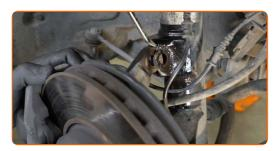
Desapertar a fixação superior de montagem do suporte do amortecedor.
