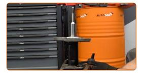
Instale a manga para poeiras e a bomba de bloqueio no novo amortecedor.
