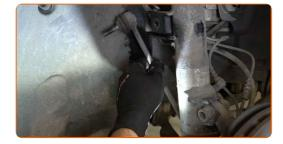
Desligue o suporte de montagem da mangueira do travão. Use um alicate de corte.
