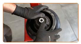
Aperte a porca do suporte do amortecedor da haste do pistão. Chave para a porca do amortecedor de 14X2.5 mm. Use uma chave soquete nº 21. Use HEX n.º H6. Use uma chave de torque. Aperte-o para o torque de 20 Nm.
