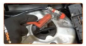
Solte o fixador superior do apoio da coluna de suspensão. Use uma chave combinada nº 21. Use HEX n.º H7 Use uma chave de catraca.
