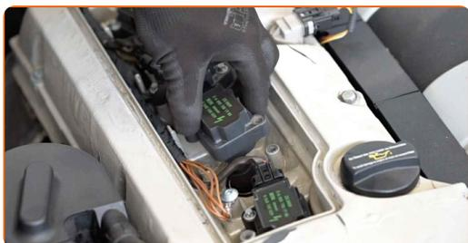
**8** Trate a ponta da bobina de ignição. Use massa de alta temperatura. Use uma chave de fenda plana.
