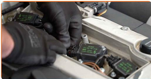
**6** Desaperte o suporte da bobina de ignição. Use uma chave soquete nº E8.
