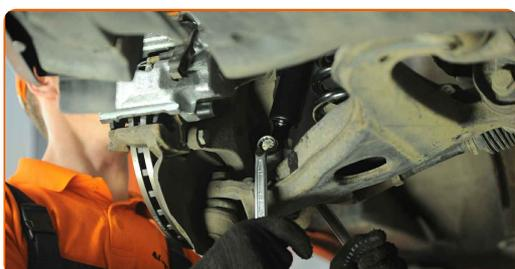
**26** Trate os fixadores do amortecedor. Use massa de cobre.
