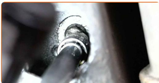
**8** Remova o parafuso de fixação.
