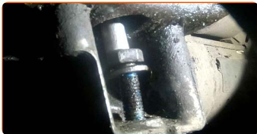
**7** Desaperte o fixador inferior do apoio do motor. Use uma chave soquete nº 13. Use uma chave de catraca.
