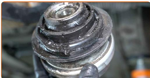
**11** Limpe o assento de montagem do apoio do motor. Use uma escova metálica. Use o spray de limpeza universal.
