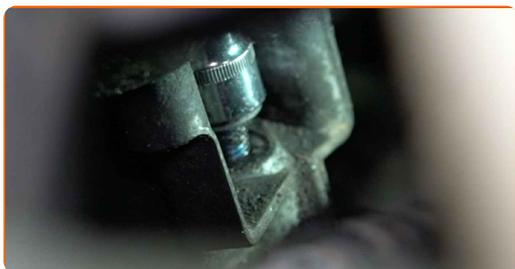
**6** Remova o parafuso de fixação. Use um ímã telescópico.
