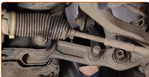
**23** Aparafuse os fixadores, que ligam o garfo da suspensão ao braço inferior de controlo. Use uma chave combinada nº 18. Use uma chave soquete nº 22. Use uma chave de catraca.
