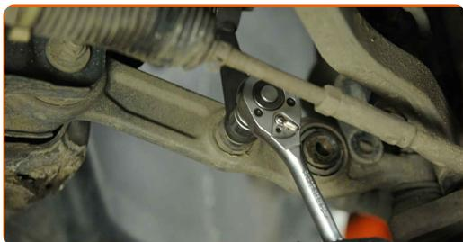
**20** Aperte o fixador da bieleta da barra estabilizadora. Use uma chave soquete nº 21. Use uma chave de catraca.
