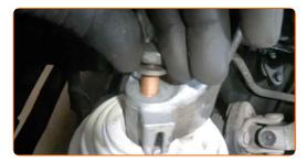
Aparafuse o elemento de fixação superior do suporte do motor. Use uma chave soquete nº 16. Use uma chave de catraca.
