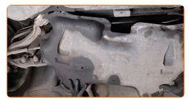
Limpe os fixadores do apoio do motor. Use uma escova metálica. Use spray WD-40.
