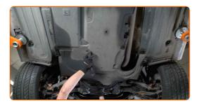
Aperte os fixadores da tampa inferior do cárter. Use uma chave soquete nº 10. Use uma chave de catraca.
