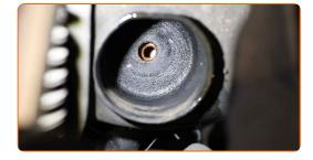
Aparafuse o elemento de fixação inferior do suporte do motor. Use uma chave soquete nº 16. Use uma chave de catraca.
