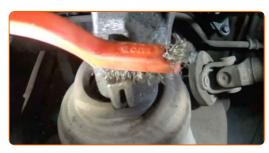
Desaperte o fixador superior do apoio do motor. Use uma chave soquete nº 16. Use uma chave de catraca.
