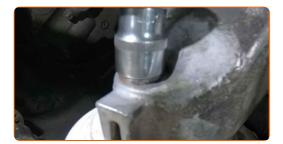
Aperte o fixador superior do apoio do motor. Use uma chave soquete nº 16. Use uma chave de torque. Aperte-o para o torque de 50 Nm.
