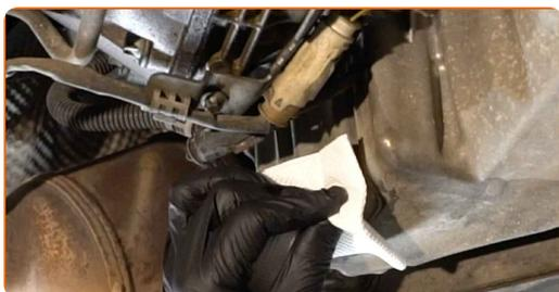
**24** Aparafuse o novo bujão de drenagem e aperte-o. Use uma chave soquete nº 13. Use uma chave de torque. Aperte-o para o torque de 30 Nm.
