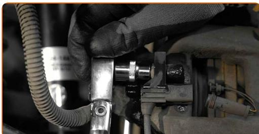
10 Remova o parafuso de fixação.
