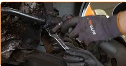
**8** Retire os parafusos de fixação.
