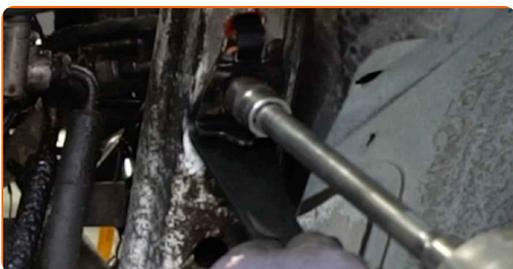
**21** Instale os parafusos de fixação.
