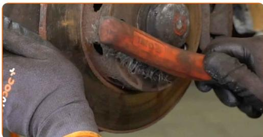
**28** Trate a superfície onde o disco de travão entra em contacto com a jante. Utilize massa lubrificante de cerâmica.
