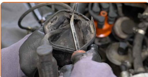
**18** Insira o cabo de alta tensão novo na tampa da bobina de ignição.
