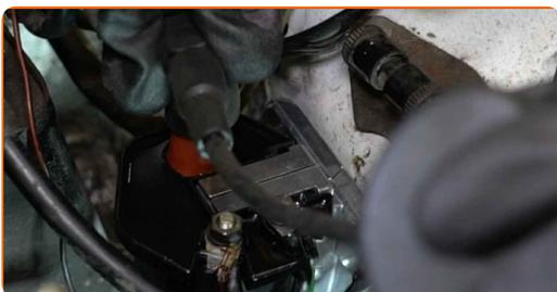
**20** Coloque a tampa da bobina de ignição.
