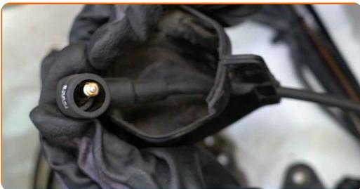
**19** Conecte o cabo de alta tensão à bobina de ignição.
