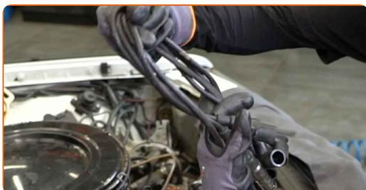
**12** Trate os terminais do distribuidor de ignição. Use uma escova metálica. Use graxa dielétrica.
