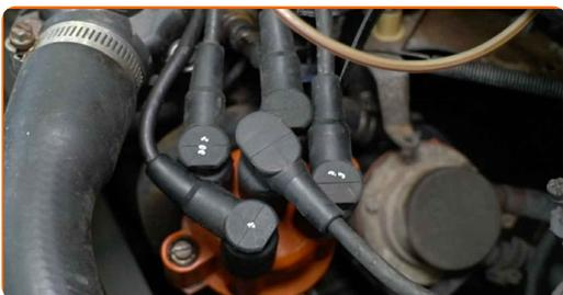
**9** Desconecte os cabos da vela de ignição das velas de ignição.
