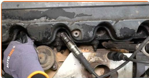
**10** Desconecte os cabos de alta tensão do distribuidor da ignição.
