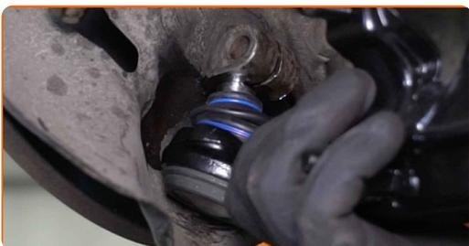
**23** Instale o parafuso de fixação.
