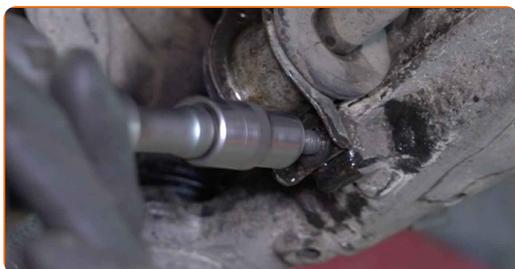
**13** Desmonte a barra estabilizadora do braço de suspensão.
