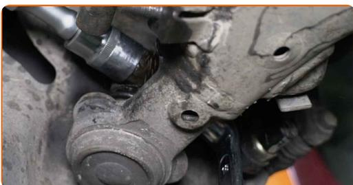
**15** Remova o parafuso de fixação.
