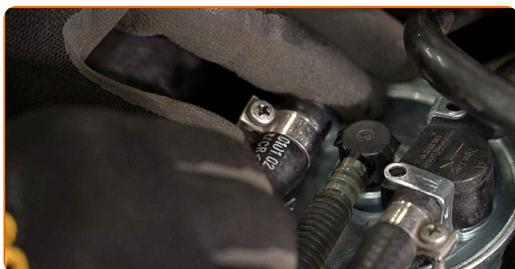
**15** Aparafuse o elemento de fixação que liga a linha de combustível ao alojamento do filtro de combustível. Use a chave Phillips.
