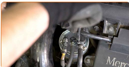
**16** Aperte o grampo de fixação do tubo do filtro de combustível. Use a chave Phillips.
