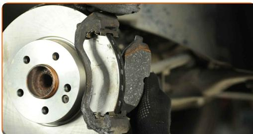
Substituição: pastilhas de travão – MERCEDES-BENZ Sprinter 4-t Tourer (907).
