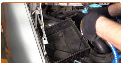
Substituição: filtro de ar – MERCEDES-BENZ Sprinter Camião basculante (W905). Os profissionais recomendam:
