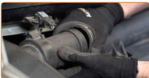
5 Desconecte o conector do medidor de massa de ar.
