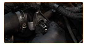
Aparafuse o fixador do suporte. Use Torx E11. Use uma chave de catraca.
