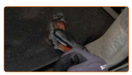
Desaperte o bujão de drenagem. Use uma chave soquete nº 13. Use uma chave de catraca.
