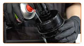
Instale anéis em O novos e um filtro de óleo novo nos seus locais de montagem na tampa do filtro.
