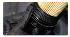
24 Instale a tampa da carcaça do filtro de óleo e aparafuse-a.
