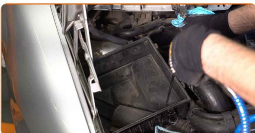
Substituição: filtro de ar – MERCEDES-BENZ Sprinter Classic 4,6-t Van (W909).
