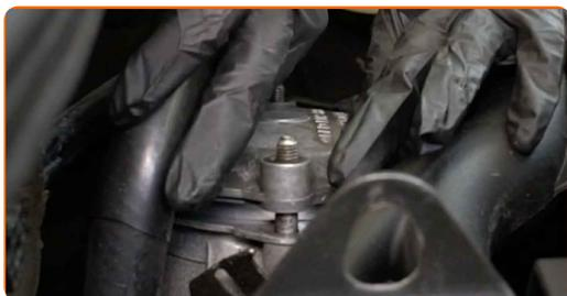
**25** Aperte as porcas da tampa da carcaça do filtro de óleo. Use uma chave soquete nº 13. Use uma chave de torque. Aperte-o para o torque de 25 Nm.
