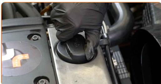
**32** Ligue o motor por alguns minutos. Após a luz de advertência da pressão do óleo se apagar, desligue o motor.
