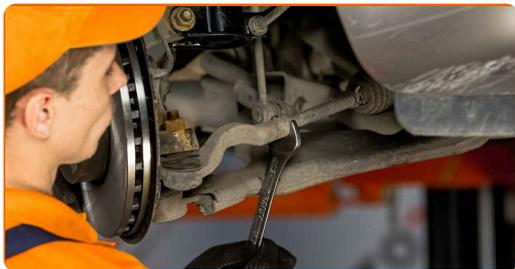
**9** Limpe o elemento de fixação que conecta o terminal de direção à manga de eixo. Use uma escova metálica. Use spray WD-40.
