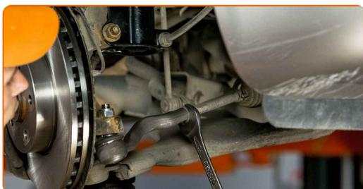
**18** Aplique produto em todas as conexões do terminal da barra de direção. Use massa de cobre.
