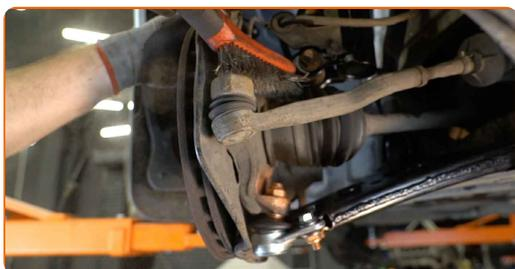
**10** Desenrosque a extremidade da porca de fixação da manga de eixo. Use uma chave soquete nº 21. Use uma chave de catraca.
