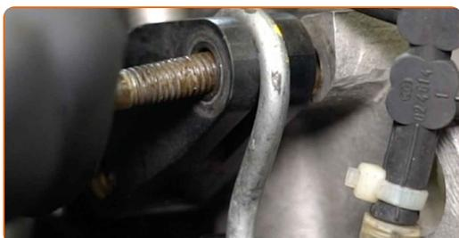
**8** Enrosque o parafuso de fixação do tensor da correia. Use uma chave combinada nº 16 (2 peças).
