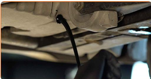
**Substituição: óleo do motor e filtro – MERCEDES-BENZ Vito Van (W638).**
