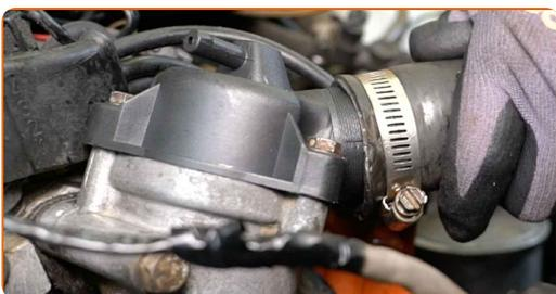
**22** Fixe a braçadeira de fixação da mangueira do líquido de refrigeração. Use uma chave soquete nº 8. Use uma chave de catraca.
