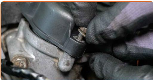
**20** Aperte os fixadores da carcaça do termóstato. Use uma chave soquete nº 10. Use uma chave de torque. Aperte-o para o torque de 12 Nm.
