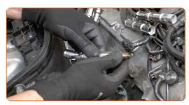
Aplique uma camada fina de um lubrificante antigripante de alta temperatura específico às roscas das novas velas de ignição.
