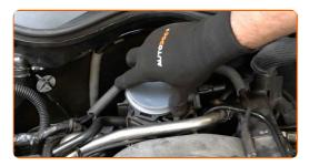
Desconecte os conectores das bobinas de ignição.
