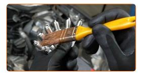
Instale as velas de ignição novas nos seus locais de montagem.
