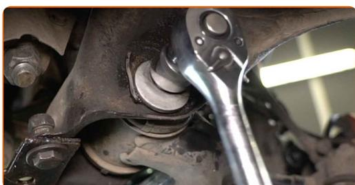
**11** Desaparafuse o fixador dianteiro do braço de controlo. Use uma chave combinada nº 22. Use uma chave soquete nº 22. Use uma chave de catraca.
