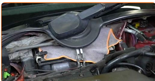
**10** Limpe os parafusos do mecanismo do limpapa-brisas. Use uma escova metálica. Use spray WD-40.
