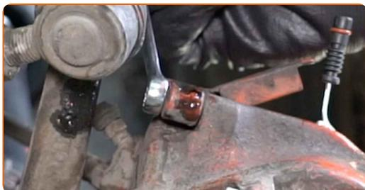
**11** Remova o parafuso de fixação.
