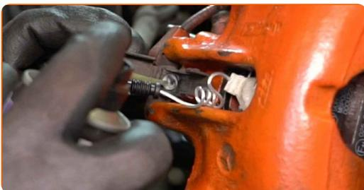
**66** Junte o conector do sensor de desgaste da pastilha de travão.
