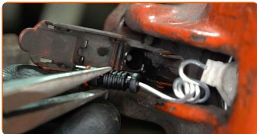
**9** Limpe o elemento de fixação do conector do sensor de desgaste da pastilha do travão. Use uma escova metálica. Use spray WD-40.
