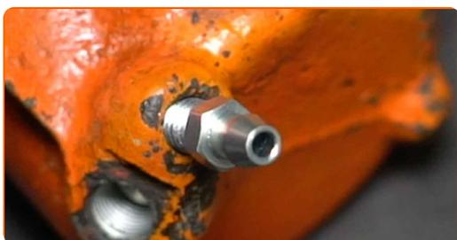
**45** Limpe o local onde o tubo do travão está ligado à pinça. Use uma escova metálica. Use o spray de limpeza universal.
