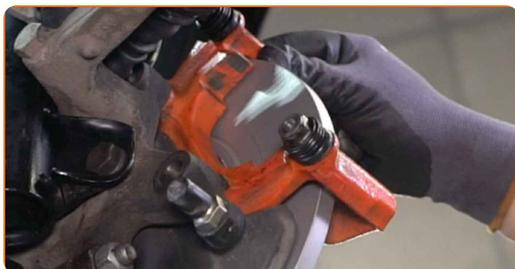
**47** Instale os parafusos de fixação.
