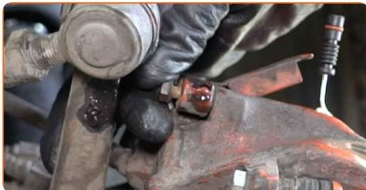
**12** Desmonte o conector do sensor de desgaste da pastilha de travão.
