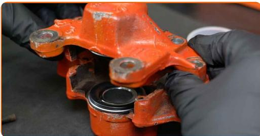
**37** Instale os parafusos de fixação.
