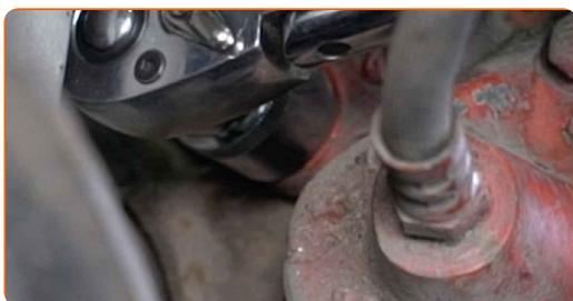
**18** Retire os parafusos de fixação.
